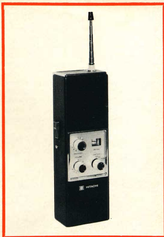
Fig. 2 - Radiotelefono portatile « Hitachi » (G.B.C. zz/1840-00 ch 1330r) frequenza 27 MHz due canali. TX = 1 W (400 mWusc.), RX = 400 mW 13 transistor, 1 diodo, 1 varistor portata in mare 20-40 km.
